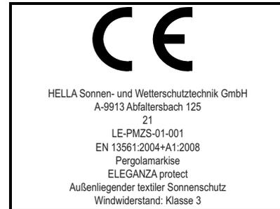
Die CE-Kennzeichnung gilt für den Auslieferungszustand des Produktes. Angaben zum Windwiderstand im montierten Zustand, sind in der Produktdokumentation festgelegt. Im montierten Zustand erfüllt das Produkt die Anforderungen der angegebenen Norm nur, wenn
